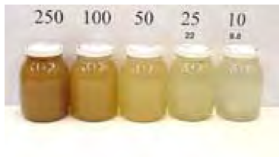
Figure 22 : Relation entre aspect d'une eau et mesure NTU
